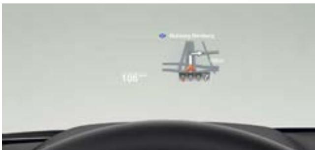
□ Das vollfarbige BMW Head-Up Display<sup>2</sup> blendet per optischer Projektion alle für die Fahrt relevanten Daten in das Sichtfeld des Fahrers ein und steigert damit die Konzentration auf das Fahrgeschehen. So werden hier ausstattungsabhängig die aktuelle Geschwindigkeit, Navigationshinweise, die Speed Limit Info inkl. Überholverbotsanzeige und Telefon- und Entertainmentlisten angezeigt.
