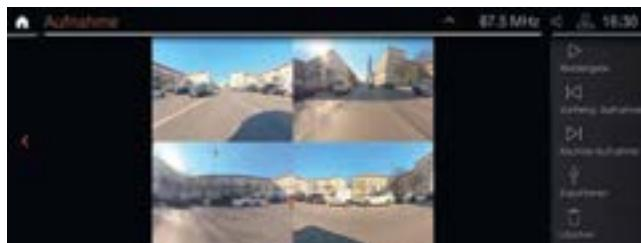
□ Der BMW Drive Recorder<sup>3</sup>, bestehend aus dem Event- und dem Crashrecorder, ermöglicht die Aufnahme eines Videos von der Fahrzeugumgebung und das Abspielen des Videos auf dem Control Display oder über USB-Export auf Ihrem Endgerät. Wichtige Fahrzeuginformationen wie z. B. Geschwindigkeit und GPS-Position werden synchron mit dem Video gespeichert.
