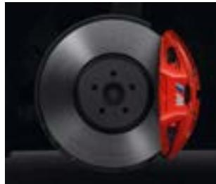
□ Die leistungsstarke M Sportbremse mit Vierkolben-Festsattel vorn und Einkolben-Faustsattel hinten in Rot hochglänzend<sup>2</sup> sowie mit M Logo verfügt über große Bremsscheiben und damit über eine besonders hohe Bremsleistung. Angepasst an das dynamische Potenzial des Fahrzeugs gewährleistet sie auch bei sportlicher Fahrweise eine hervorragende Verzögerung.
