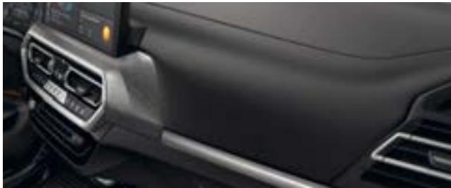
□ Die mit Sensatec bezogene Instrumententafel verleiht dem Interieur des Fahrzeugs eine hochwertige Anmutung. Das direkt auf einen Halbhartschaum kaschierte Kunstleder überzeugt durch seine weiche Oberfläche. Der widerstandsfähige Bezug ist mit attraktiven Doppelkappnähten um die Türbrüstungen vorn und hinten versehen.
